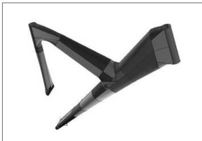
Rozdělení modelu na jednotlivé plochy, ty se potom vysítují elementy
