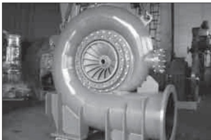
Francisova turbína, výkon 580 kW, návrh pro firmu HYDROHROM, s. r. o. Návrh provedlo VUT v Brně, umístěna na lokalitě Hermon, Arménie.
