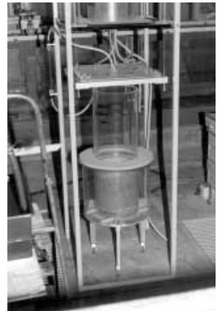
Simulátor chemických smyvů, využívaný k testování splachů ze zemědělských pozemků. Foto: P. Hobstová
